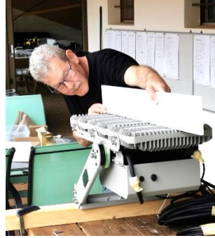
Vorbereitung der LED-Leuchten und Leuchten-Träger
